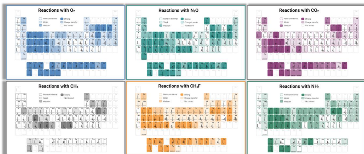
Rys 1. Gazy reakcyjne ich zastosowanie do usuwania interferencji w pomiarach ICP-MS.
